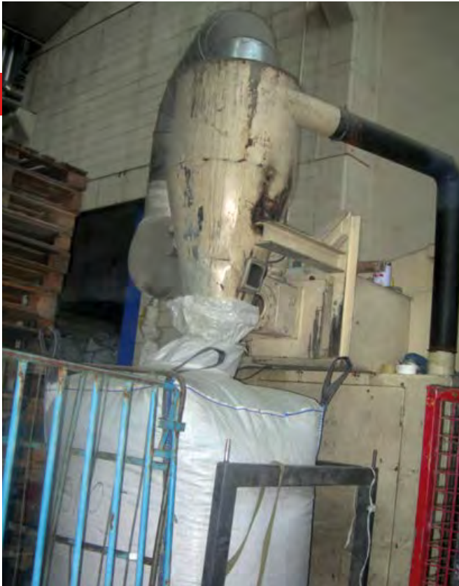
Els taps, ja trinxats, surten per aquest embut i es recullen en sacs.
