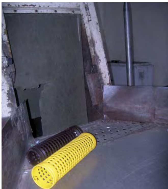
Entrada al molí que trinxa els taps. En aquesta fotografia veiem rodets procedents de la indústria tèxtil.
